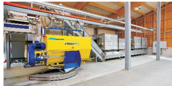
Der FMR-Roboter fährt zu den Vorratsstationen und steuert vollautomatisch die Dosierung der einzelnen Rationskomponenten.
